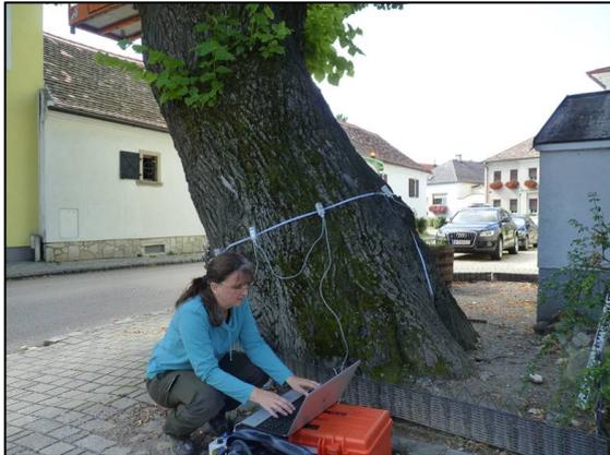
Der Schalltomograph wird verwendet zur Darstellung zweidimensionaler Querschnitte durch den Baumstamm. Damit lassen sich innere Defekte wie z.B. Holzfäulen darstellen und die Bruchsicherheit der Bäume nahezu verletzungsfrei beurteilen.
